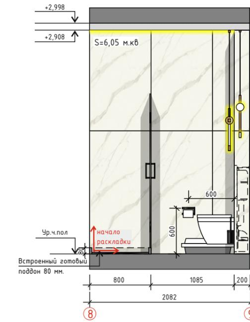
① предусмотреть ревизионный скрытый люк под отделку для обслуживания с герметиком и уплотнительной лентой для влажных зон (расположение и габариты лючка уточнит по месту)
